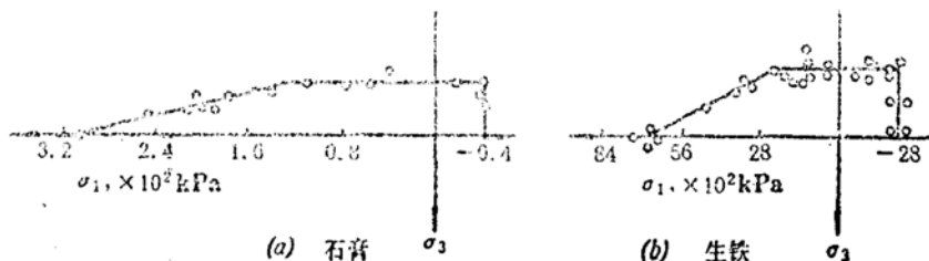
图2 脆性材料在拉压联合作用下的破坏曲线
