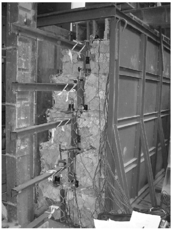
图 1 模型箱及模型挡墙
