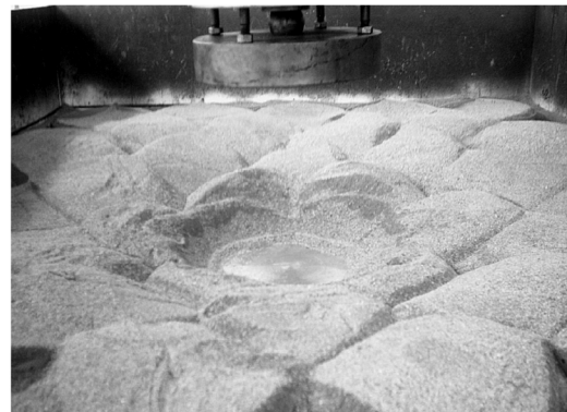
图 8 土工格室受静态承载破坏示意
