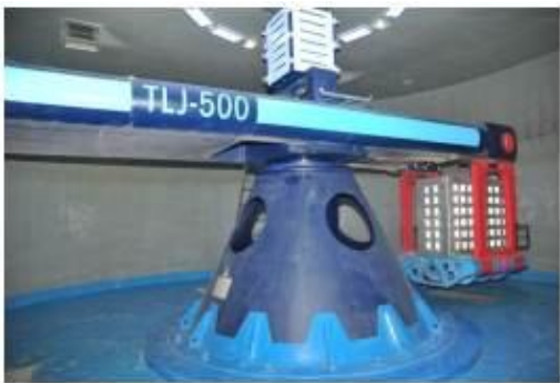
图 2 TLJ-500 型土工离心机
