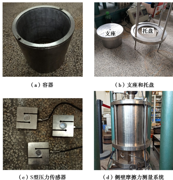
图 2 容器和侧壁摩擦力测量系统实物图
