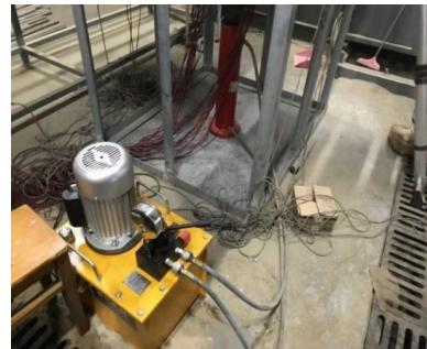
图 4 电动液压油泵及液压千斤顶
