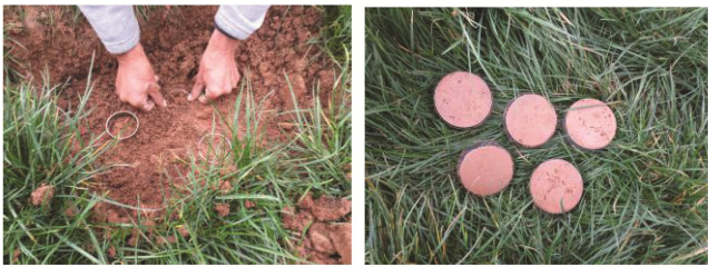
(a) 现场探坑开挖取土 (b) 取出的现场原状红黏土 图 4 现场覆盖层红黏土原状土取样
