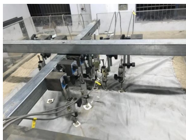
图9 地表位移测点布点照片
