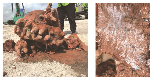
(b) 专用沉桩—嵌岩钻头、嵌岩段切削的岩渣
