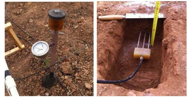
图 2 现场#1、#2 试验区张力计和 TDR 埋设
