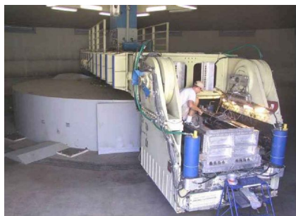
图 2 UC Davis 半径 9.1 m 大型动力离心机
