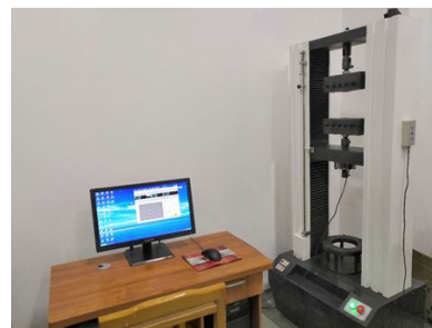
图3 DW1210 土工合成材料电子强力试验机
