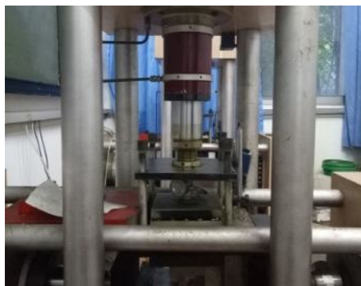
图2 YZJL-300岩石直剪流变仪
