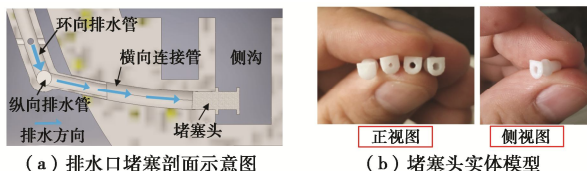
图 7 堵塞头制作及使用流程
