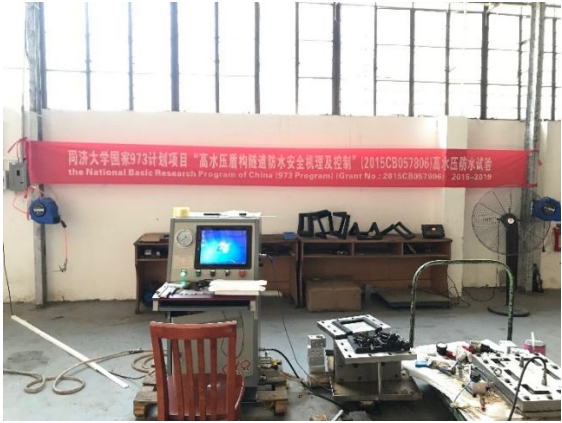
图 8 伺服式高水压接缝防水试验装置
