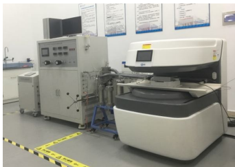
图 3 低场核磁共振分析仪 Fig. 3 Low-field NMR analyst instrument
