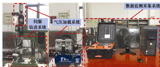
图 1 多功能数字钻进测试系统
