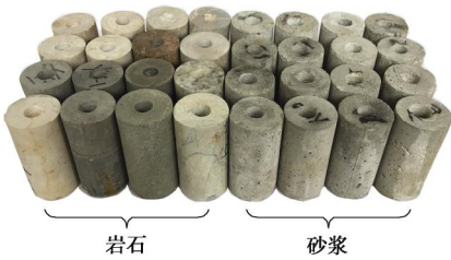
(b) 钻进试验完成后的部分试样
