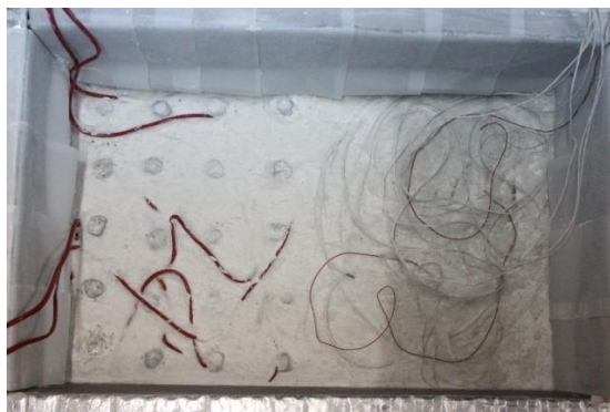
图4 冷冻完成后加筋碎石桩复合地基
