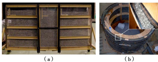
图6 矩形槽和环形槽填充试验 [26-27]
