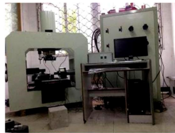
图2 YZW 1000型微机控制电动直剪仪
