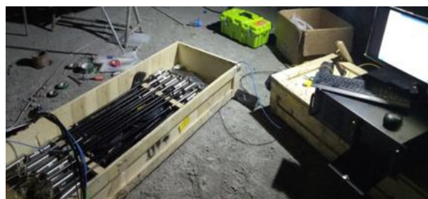
图14 现场实施的光栅光纤位移监测
