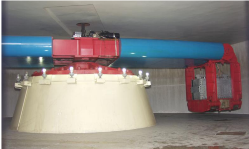
图2 NHRI 400 g-t 大型土工离心机
