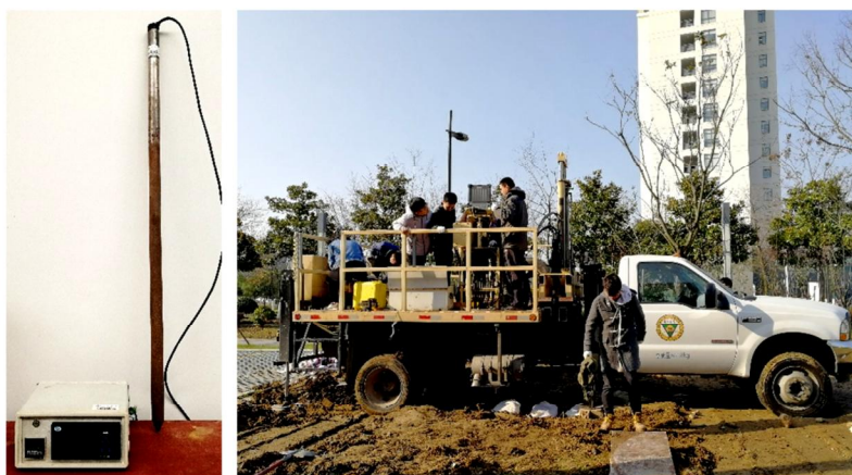
图 8 热传导 CPT 测试系统与现场测试
