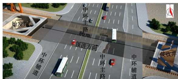
图1 管幕-箱涵下穿工程示意图
