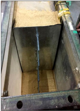
图 7 预应力返包式加筋土挡墙模型
