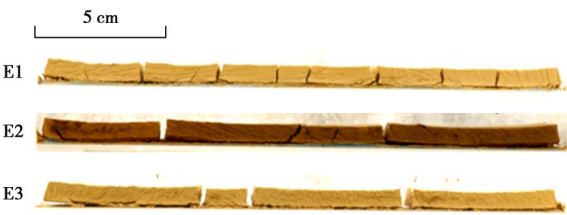
图 3 室内试验最终裂隙图像 (侧面)
