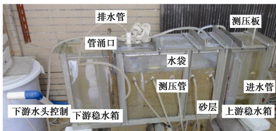
图 1 室内试验模型箱
