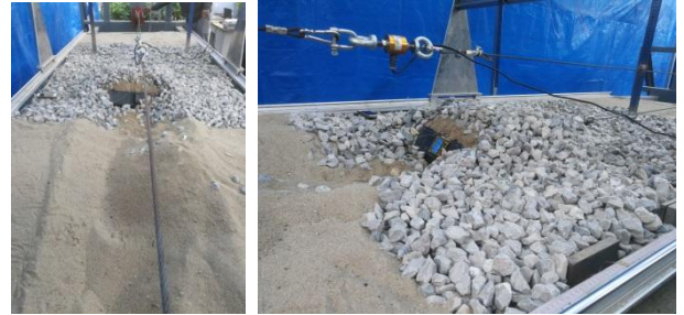
图 7 锚由砂土进入不同平均粒径的碎石层中
