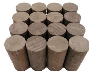
图 3 红砂岩圆柱体标准试样
