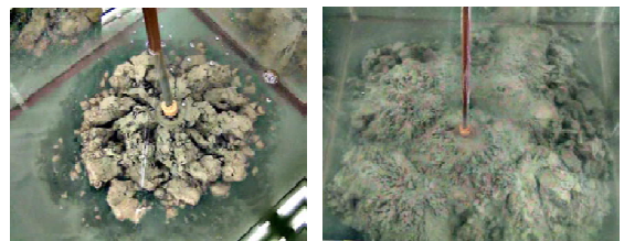
图5 第一层固化土(左)和第二层固化土(右)的浇筑情况 [12]
