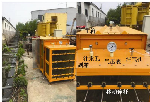
图 10 试验装置气/水密封性情况现场检验
