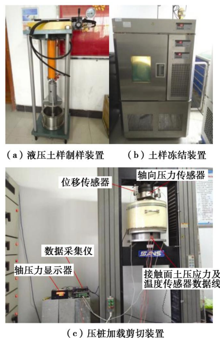
图 1 压桩法冻结强度测定系统
