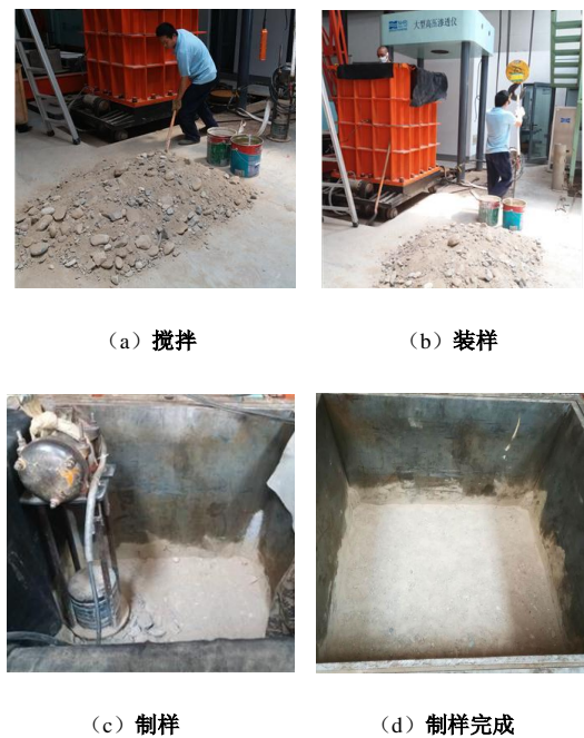
图 2 超大型渗透试样的制样
