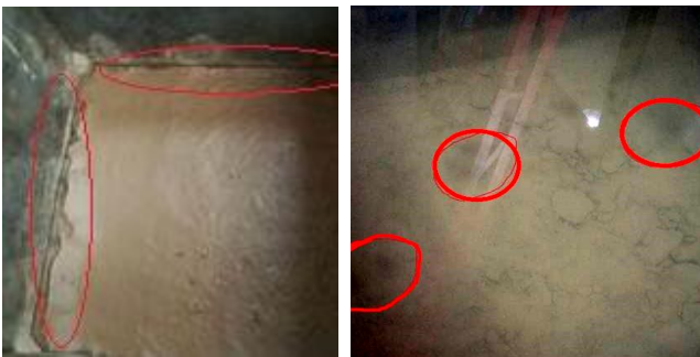
(a) 流土（上包线试样） (b) 管涌（平均线试样）
