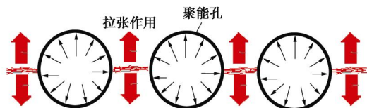
图3 双向聚能张拉爆破原理示意图
