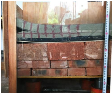
图11 侧限加筋土挡墙的实际变形形态
