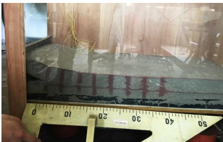
图12 无侧限加筋土挡墙的实际变形形态
