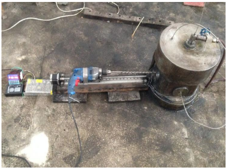
图 4 滑台导轨连接图
