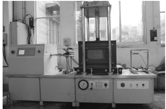
图 1 拉拔试验装置
