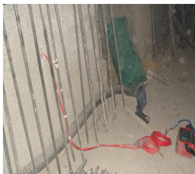
图 3 围岩温度测试现场
