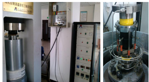
图 1 RLW-2000 岩石三轴流变仪及渗流装置
