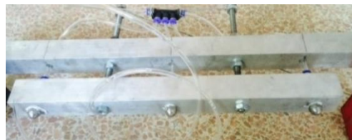
图 3 自主设计制作的降雨装置
