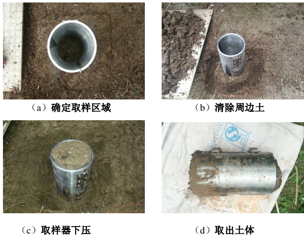
图 6 现场土样的获取过程
