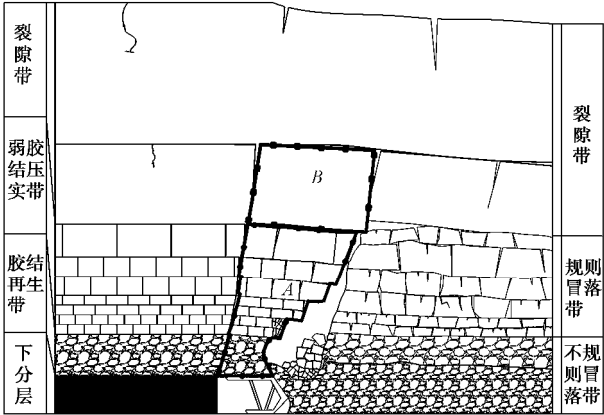
图 7 “支架-再生顶板”结构模型
