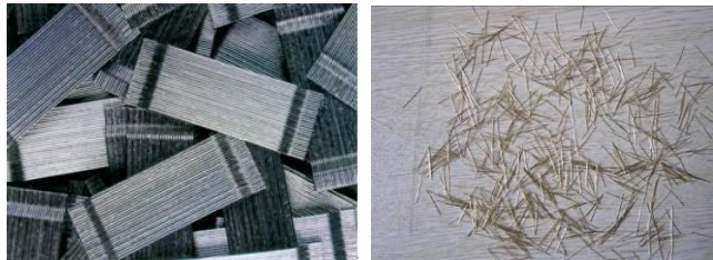
(a) 工程用钢纤维 (b) 试验用钢纤维
