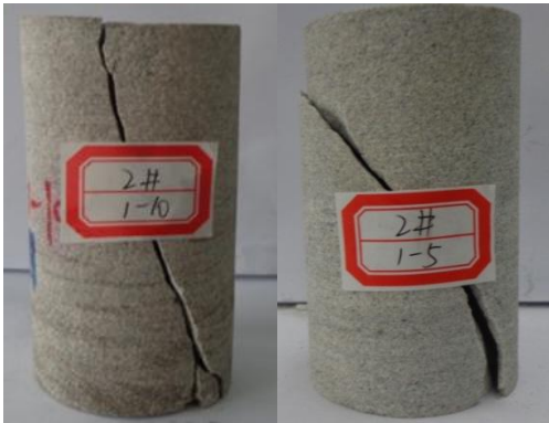
图3 岩样的标准单剪切面破坏形式
