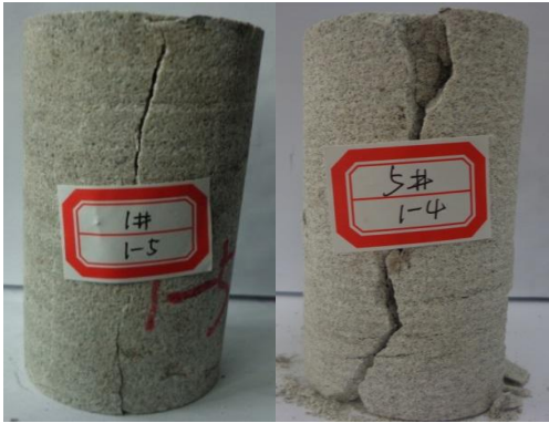
图5 岩样的标准轴向张拉破坏形式
