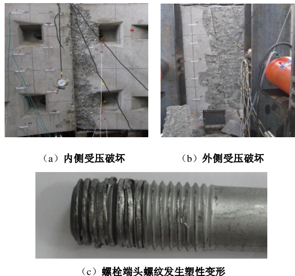
图 15 接头受压区混凝土破坏与螺栓受拉破坏
