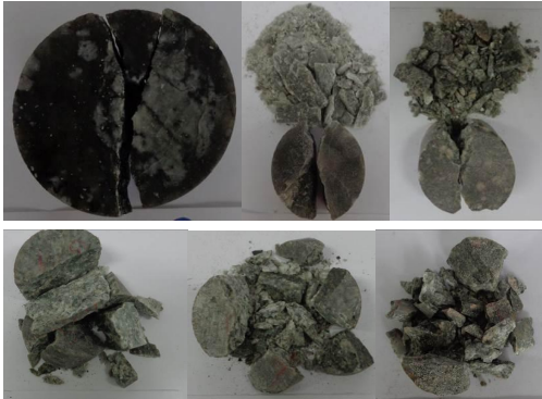
图 6 完整岩石破坏模式
