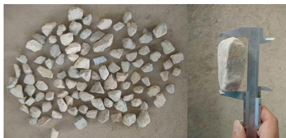
图 1 40~60 mm 碎石三向尺寸测量
