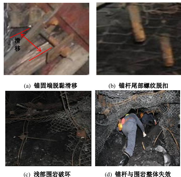
图 1 冲击载荷作用下锚杆典型失效形式
