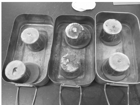
图 2 干湿循环试验中试样浸水润湿照片
