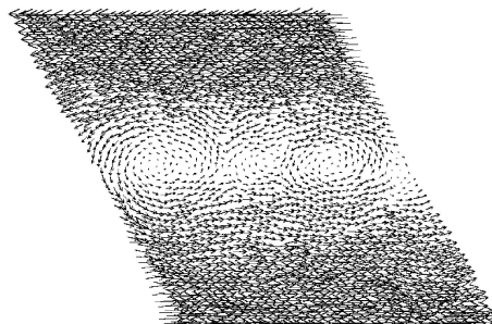
图 3 A_m=1.4 时中密离散元试样某时刻的速度场分布
