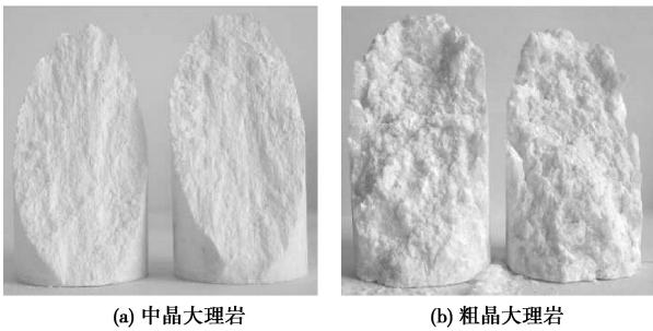
图 1 两种晶粒大理岩细观结构的对比
