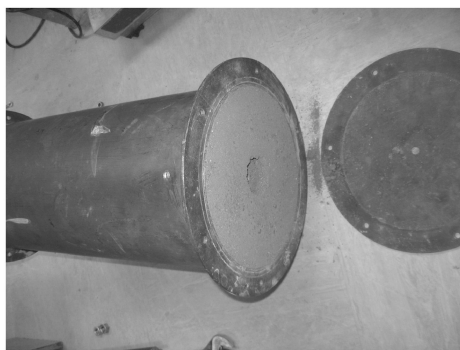
图 5 拉拔试验后土钉尾部位移情况
