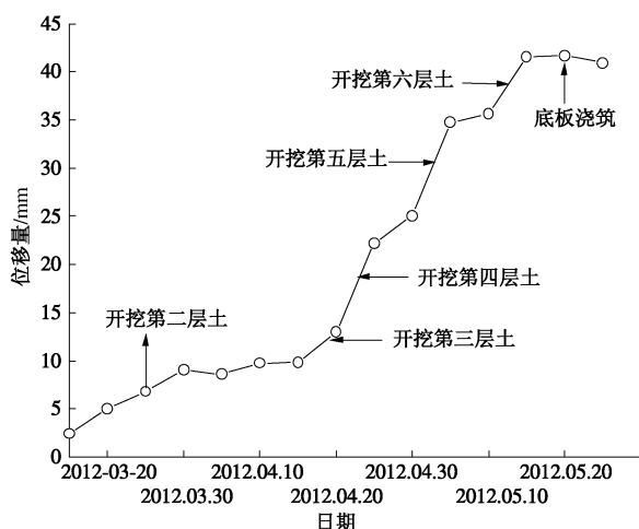
图 14 CXZ24 (18 m 处) 位移随时间变化曲线
