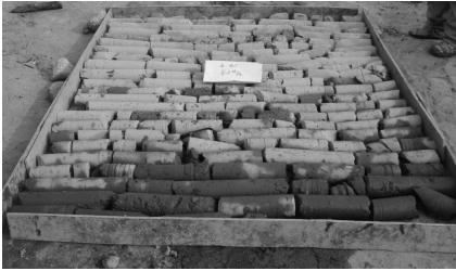
图 13 等厚水泥土搅拌墙 28 d 取芯试样
