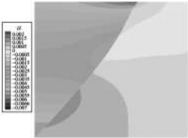
图 8 剪切带贯通时的水平位移
