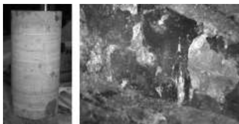
图 5 黄色弱溶蚀泥灰岩及岩体中方解石晶脉构造(80X)
