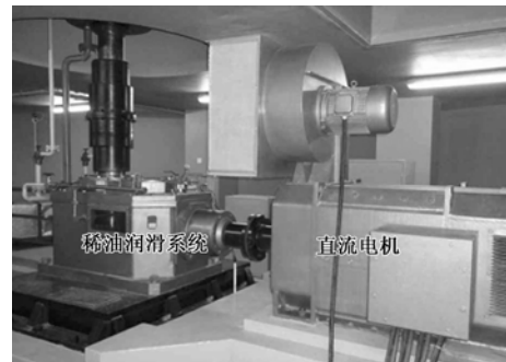
图 5 动力传输和稀油润滑系统
