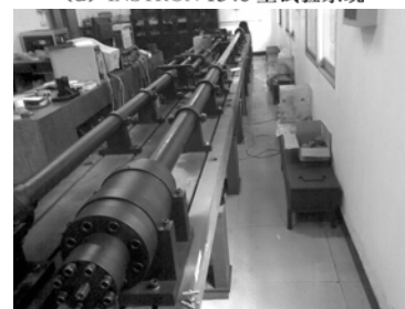
(b) \phi 75 \text{ mm} 杆径 SHPB 试验系统
