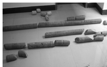
图 2 75 mm 直径砂岩岩芯
