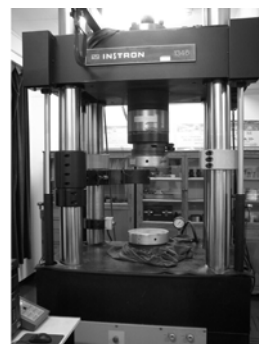
(a) INSTRON 1346 型试验系统
