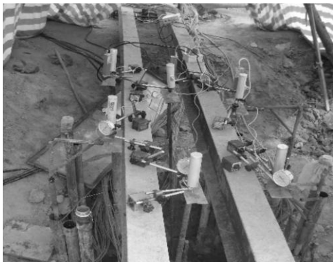
图 4 自平衡试验测试现场图
