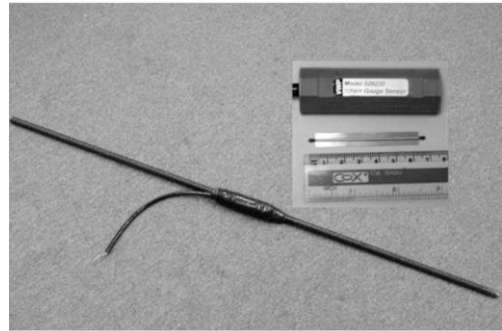
图5 应变计和感应器连接及信号电缆接长(包裹环氧树脂)
