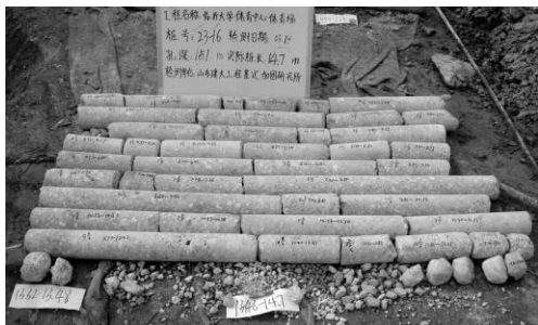
图 2 某基桩桩身芯样照片
