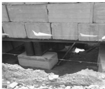
图 8 现场静载试验图片
