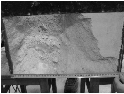
图 10 开挖面最终破坏时照片 (工况 2)
