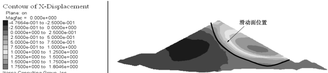
图 6 大坝临界破坏状态水平位移
