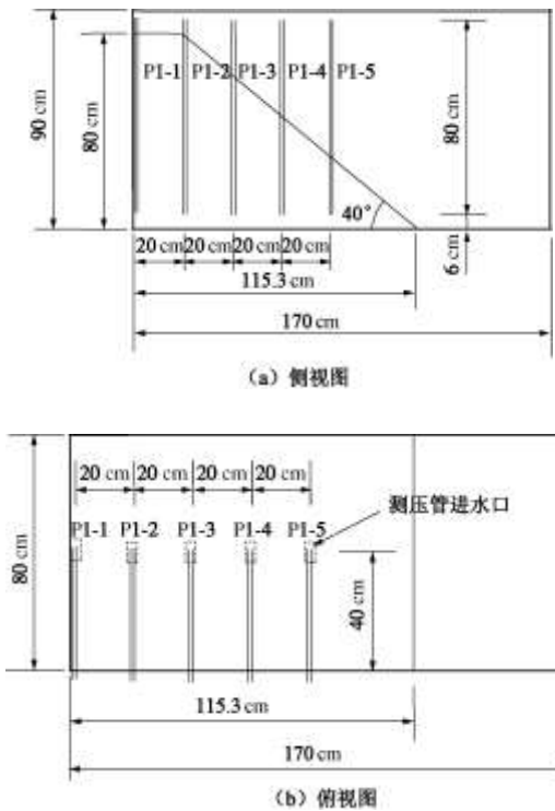
图 3 测压管布置设计图(以坡角 40° 模型为例)
