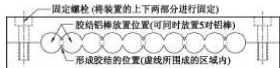
图2 胶结铝棒成型装置
