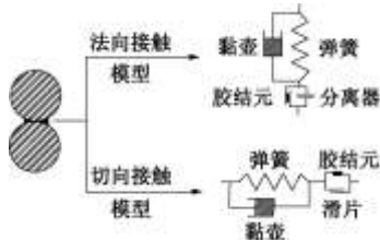
图 6 离散元中胶结接触模型 [8]
