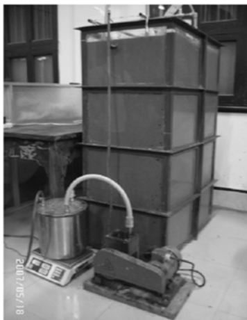
图4 透气真空模型试验初始状态
