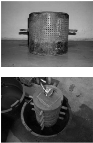
图 1 改进的 CBR 筒和施加荷载块的情况
