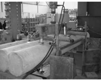
图 3 抗弯试验加载现场图
