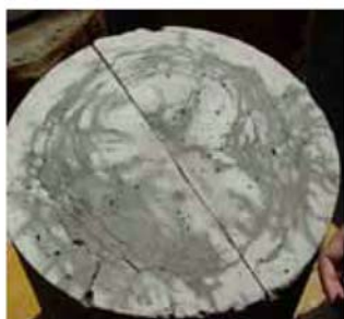
图9 预制剖面试样的上表面照片
