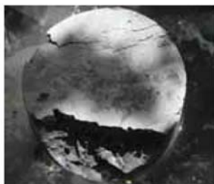
图8 拉伸破坏区照片
