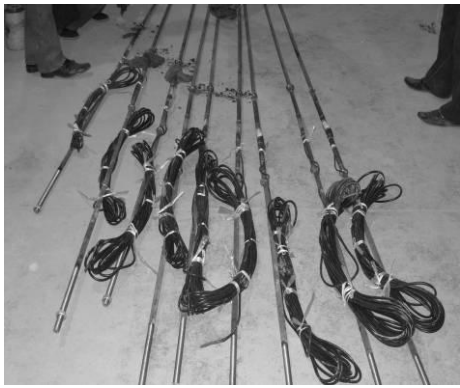
图 3 拉筋与钢筋应力计焊接成型
