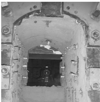
图 5 模型试验中彩色标点的布置
