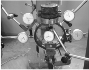
图 9 模型隧道圆环下部固定上部受集中荷载布置图
