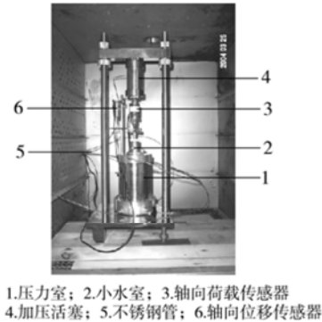
图 4 温控土工三轴压力室照片(置于恒温箱内)
