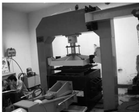
图6 改进后的大型土石混合料多功能试验机
