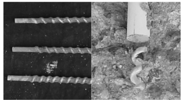
图 8 拉拔试件的破坏特征
