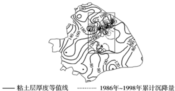
图 18 粘土层厚度等值线图
