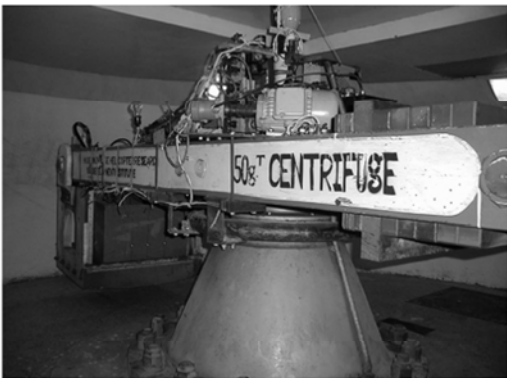
图 2 清华大学 50gt 中型离心机 Fig. 2 50gt geotechnical centrifuge at Tsinghua University
