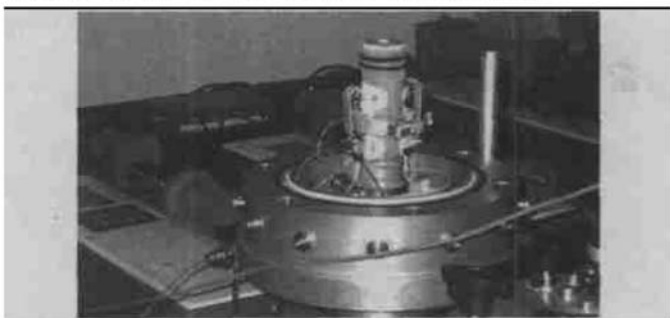
图4 安装就位的霍尔效应传感器
